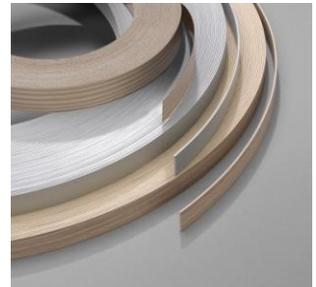
EGGER Sicherheitskanten ABS sind thermoplastische Kanten zur dekorativen Schmalflächenbeschichtung von Holzwerkstoffen und übernehmen eine Schutz- und Designfunktion. EGGER Sicherheitskanten werden aus ABS (Acrylnitril-Butadien-Styrol) hergestellt und sind vollflächig durchgefärbt. Die Rückseite ist mit einem Universal-Haftvermittler (Primer) versehen.
