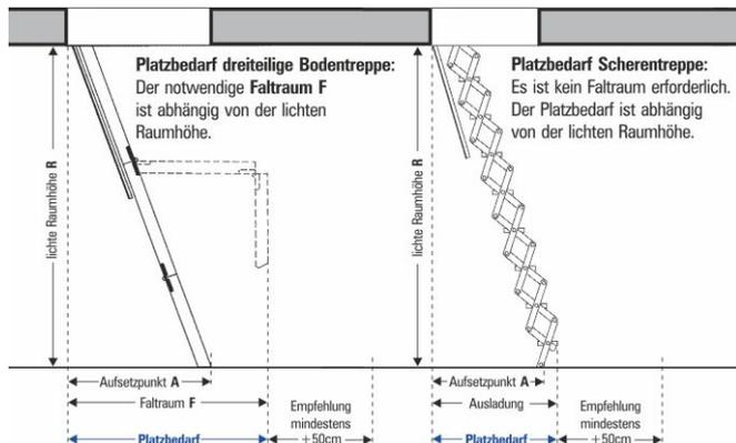
Der genaue Platzbedarf (= Faltraum bei dreiteiligen Bodentreppen bzw. Ausladung bei Scherentreppen) ist abhängig von Raumhöhe, Treppentyp, Zusatzausstattung. Wir empfehlen zusätzlich mindestens 50 cm mehr Platz zum Bedienen und Begehen der Treppe. Maße immer online prüfen unter [www.massbox.de](http://www.massbox.de)
