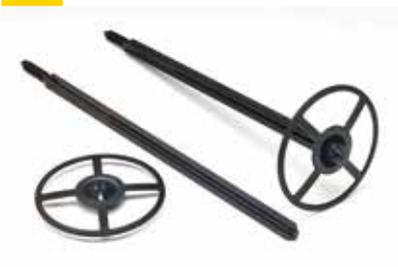
Bei der Montage des Dämmstoffhalters Kontur DH wird durch die Fassaden-Dämmplatten bis ins Mauerwerk hinein ein Loch gebohrt (Bohrlochdurchmesser 8 mm; Bohrlochtiefe  $\geq$  40 mm). Der Schaft wird in Durchsteckmontage durch die Fassaden-Dämmplatten mit einem Hammer eingeschlagen. Nachdem der Schaft montiert ist, wird der Teller auf den Schaft gesteckt und bis zur Fassaden-Dämmplatte aufgeschoben. Der Teller muss vollständig auf der Fassaden-Dämmplatte aufliegen.
