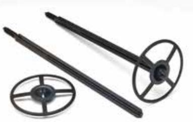
Bei der Montage des Dämmstoffhalters Kontur DH wird durch die Fassaden-Dämmplatte bis ins Mauerwerk hinein ein Loch gebohrt (Bohrlochdurchmesser 8 mm; Bohrlochtiefe  $\geq 40$  mm). Der Schaft wird in Durchsteckmontage durch die Fassaden-Dämmplatte mit einem Hammer eingeschlagen. Nachdem der Schaft montiert ist, wird der Teller auf den Schaft gesteckt und bis zur Fassaden-Dämmplatte aufgeschoben. Der Teller muss vollständig auf der Fassaden-Dämmplatte aufliegen.
