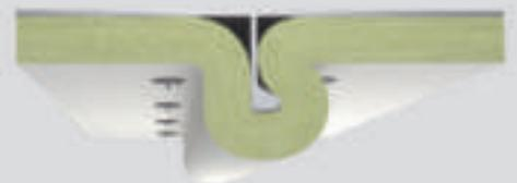
Die ULTIMATE U SeaProtect Platte wird ohne Zuschneiden flexibel um die Steifen gelegt und anschließend mit Pins befestigt. Dies spart Arbeitszeit und verringert den Verschnitt und somit die Materialkosten im Vergleich zu traditionellen Steinwollelösungen.
