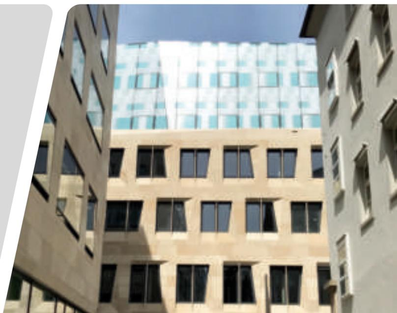
Dorotheen Quartier Stuttgart: Die vorgehängte hinterlüftete Fassade ist brandsicher und hocheffizient mit ULTIMATE gedämmt.
