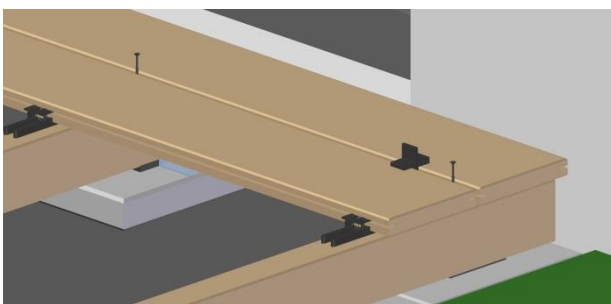
Bild 11. Beiliegende Schrauben einsetzen und festschrauben
