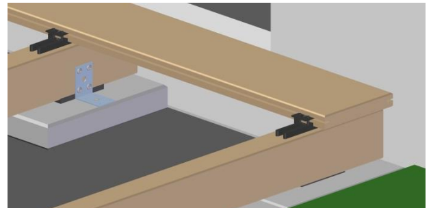
Bild 8. Je Unterkonstruktion 1 H-Stick verwenden.
