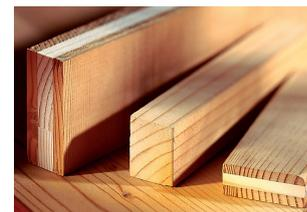
Die Bearbeitung erfolgt mit handelsüblichen Holzbearbeitungsmaschinen wobei auf einen sauberen, exakten Kantenschnitt zu achten ist. Waagrechte Kanten sind immer mit 15° Schräge zu schneiden, damit an der Oberseite ein Abfließen von Flüssigwasser erfolgen kann und an der Unterseite eine exakt definierte Tropfkante entsteht.
