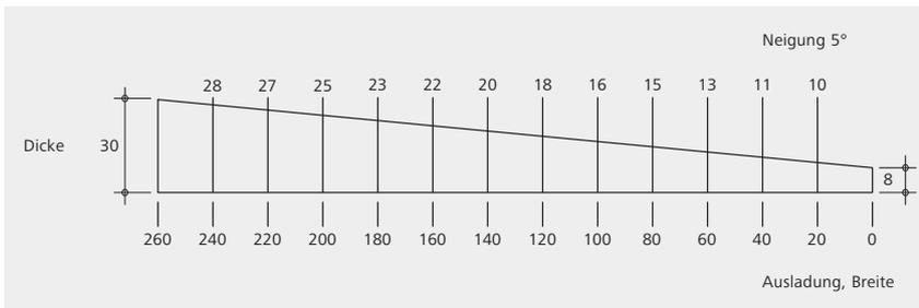
a) Konisch auslaufend; Dämmkeildicke mit dem Fensterhersteller abstimmen; ggf. Rahmen-Aufdopplung einplanen
