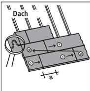
Die Verlegung in der ersten Reihe beginnt im Verband von links unten. Die Feder weist nach oben, der Plattenaufdruck zeigt an, welche Plattenseite nach innen bzw. außen zeigen muss. Mit dem Abschnitt der letzten
