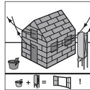
STEICO Unterdeckplatten sind diffusionsoffene Holzfaser-Dämmplatten. Kondensatbildung auf der raumzugewandten Plattenseite während der Bauphase stört (behindert) den Diffusionsstrom.
