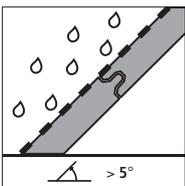
Die Verarbeitung von STEICOsafe mit integrierten Selbstklebestreifen ist bei Temperaturen  $> 5^\circ$  Celsius durchzuführen. Die Klebeverbindung ist zusätzlich mit einer Hartgummirolle unter Druck anzupressen.
