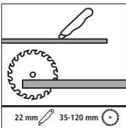
Der Zuschnitt der Platten erfolgt je nach Dicke mit einem geeignetem Messer oder mit Sägen. Bei Anschlüssen an andere Bauteile ist auf saubere und in geringem Abstand parallel geführte Schnitte zu achten. Für alle
