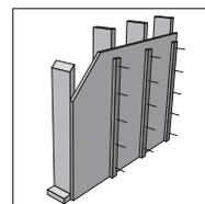
a) Bitte beachten Sie die zeitlich direkte Verlegung der Konterlattung bei Montage der Unterdeckplatte.
