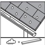
Es ist auf eine ungehinderte Feuchteabfuhrung (Hinterlüftung) auf der Bauteil-Außenoberfläche zu achten. STEICO Holzfaser-Dämmplatten sind vor dauerhafter, stehender Feuchte zu schützen. Durchfeuchtete Produkte müssen vor weiteren Baumaßnahmen zurückgetrocknet werden. Hierbei ist für ausreichende Belüftung zu sorgen.
