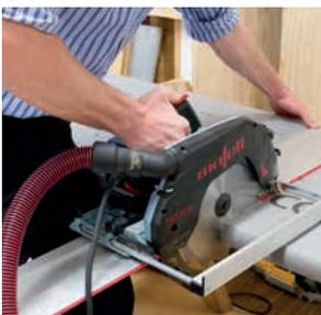
Der Zuschnitt der Platten erfolgt mit geeigneten Schneidwerkzeugen der Holzbearbeitung. Bei Anschlüssen an andere Bauteile ist auf saubere und in geringem Abstand parallel geführte Schnitte zu achten. Um die Überlappungen der
