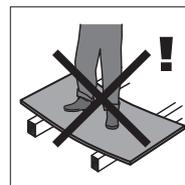
STEICO Unterdeckplatten sind im Aufgabebereich trittfest. Gemäß den Richtlinien des ZVDH und des Hauptverbandes der gewerblichen Berufsgenossenschaften gelten jedoch Unterdeckungen mit Holzfaser-Dämmplatten grundsätzlich
