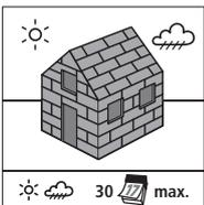
STEICO Unterdeckplatten können bis zu 4 Wochen als Behelfsdeckung eingesetzt werden, STEICOsafe 8 Wochen. Die Zeit der Freibewitterung kann bis auf 12 Wochen verlängert werden, sofern die Unterseite der Unterdeckplatte einsehbar ist und evtl. eingedrungene Feuchtigkeit ungehindert abtrocknen kann. Hohe Auflasten wie z.B. von Schnee sind zu vermeiden.
