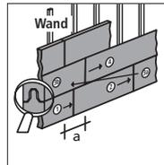
Der Versatz der vertikalen Stoßfugen je Verlegereihe erfolgt gefachweise. Bei STEICO*universal*  $d=22/24$  mm wird ein Versatz (a) im Plattenverband von 600 mm empfohlen, bei allen weiteren Plattendicken von mindestens
