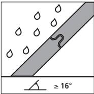
STEICO Unterdeckplatten sind mit einer umlaufenden winddichtenden und wasserableitenden Profilierung der Plattenkanten versehen. Zusätzliche Fugenabklebungen der werksseitig profilierten Plattenstöße sind im Wandbereich und bei Dachneigungen von mindestens 16° und einer maximalen Unterschreitung der Regeldachneigung der Dachziegel um 8° nicht erforderlich.
