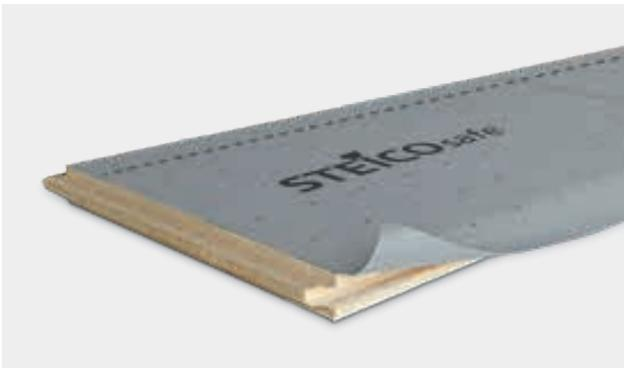
Bei STEICOsafe handelt es sich um eine Unterdeckplatte mit vollflächiger aufkaschierter Unterdeckbahn. Diese Platte wurde für geringe Dachneigungen konzipiert und kann im Bereich regensicherer Anforderungen verwendet werden.
