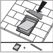
Oberhalb in der Fläche liegende Öffnungen (z.B. Dachflächenfenster = DFF) sind durch geeignete Wasserableitung zu schützen. Insbesondere bei einer Nutzung als vorläufiger Wetterschutz ist auf eine rückstaufreie und kontrollierte Ableitung des anfallenden Wassers, schon während der Bauphase, zu achten.
