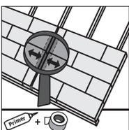
Dehnungsfugen sind bei Verlegelängen >20 m empfehlenswert. Wurden diese im vorhandenen Baukörper bereits vorgesehen, sind sie in der Ebene von STEICO Unterdeckplatten fortzuführen.
