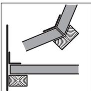
Stumpfe Stöße, Anschlüsse an andere Bauteile, Durchdringungen etc. sind zu unterstützen und sorgfältig mit geeignetem STEICO*multi* Abdichtungssystem abzukleben und gegebenenfalls oberseitig mit einer Lattung zu sichern.
